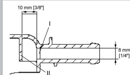
Внимание: должна быть просверлена только первая перегородка (I), поскольку на расстоянии 10 мм за первой перегородкой расположена вторая перегородка (II).
