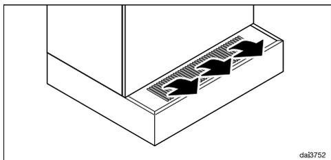
Per la selezione della posizione d'incasso, tenere conto che per il funzionamento a riciclo le aperture di riciclo aria sul lato anteriore dell'apparecchio non devono essere coperte dal mobile.
