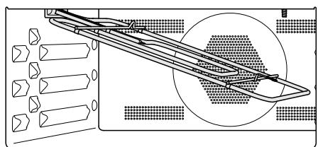
■ Pliegue hacia abajo con mucho cuidado la resistencia calefactora de bóveda y grill.
