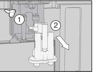
Otpustite mlječni vod s jedinice za izlaz tekućine ①. Povucite nastavak središnjeg izlaza prema dolje ②.
