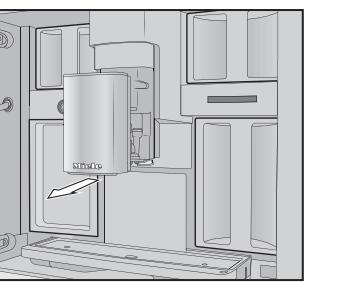
Uklonite pokrov od plemenitog čelika sa središnjeg izlaza i očistite pokrov.
