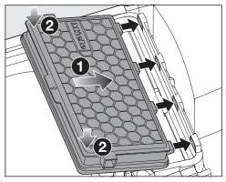
■ 插入新的空气过滤网,确保其正确插 入,然后将其向下按压到位。
