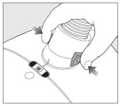
■ 按下软管连接器侧面的释放按钮,将 软管从吸尘口中拉出。
