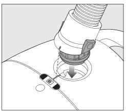
■ 将软管连接器插入吸尘器的吸尘口, 直至其卡入到位。要卡入到位,需将 两个部件上的导轨对齐。
