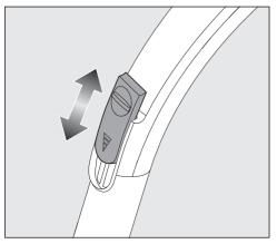
■ 将把手上的进气阀打开至最终位置, 降低吸力。
