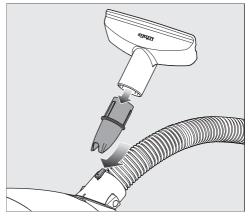
■ 如有必要,可将配件架固定到吸尘器 的软管连接器插座上。确保其卡入到 位。
