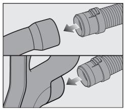
■ 将吸尘软管连接器安装到手柄中,直至卡入到位。
