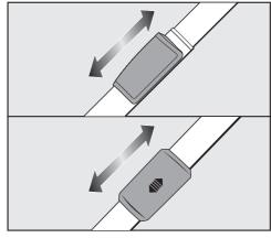
■ 握住释放装置,将伸缩管长度调整到 合适状态。
