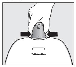
■ 按下软管连接器侧面的释放按钮,将 软管从吸入口中抬出。
