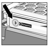
1. 如要用过滤网 b、c、d 或 e 更换空气 过滤网 a,在安装新的空气过滤网之 前,必须拆下过滤网格栅。
