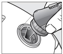
■ 将软管连接器插入吸尘器的吸入口, 直至其卡入到位。要卡入到位,需将 两个部件上的导轨对齐。
