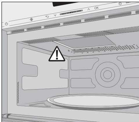
Não retire a cobertura diante da abertura de saída de micro-ondas no interior do forno.
