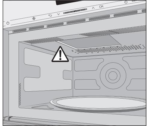
Não retire a cobertura situada no interior do forno, na zona de saída de micro-ondas.
