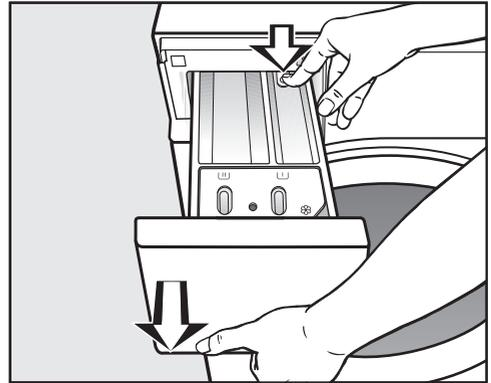
■ Ouvrez le bac à produits jusqu'à la butée, pressez le bouton de déverrouillage et sortez entièrement le bac à produits.
