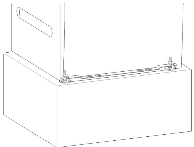
Mit dem beiliegenden Befestigungsbügel wird das Gerät über die beiden vorderen Standfüße am Boden befestigt. Das Befestigungsmaterial ist für eine Dübel-Befestigung auf Betonboden ausgelegt.
