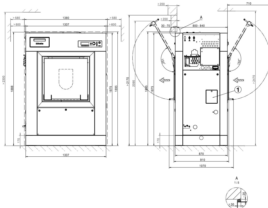
Misure in millimetri
