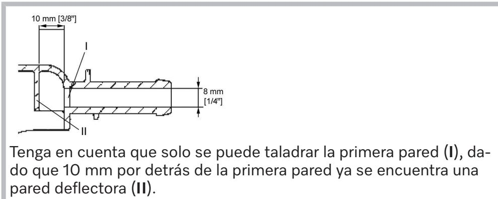
Las conexiones **3 a 12** están previstas para los detergentes líquidos. A estas conexiones no podrá conectarse ningún dispositivo de dosificación de presión alta con acompañamiento de agua. Los conductos de conexión se encuentran cerrados y, antes de su conexión, deben serrarse con una sierra pequeña hasta conseguir el diámetro de la manguera.
