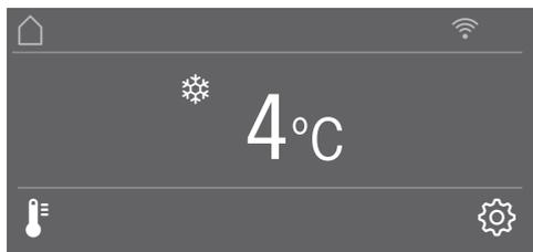
Las teclas sensoras situadas debajo de la indicación de temperatura se pueden **seleccionar** tocándolas, mientras que los símbolos y los textos que aparecen en la indicación de temperatura o por encima de ella solo se **visualizan**.
