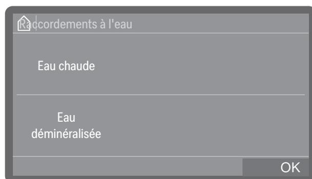
Effleurez pour sélectionner ou désélectionner les raccords à l'eau. Les raccords à l'eau activés sont mis en évidence en couleur.
