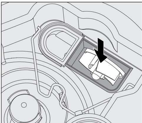
Sous le clapet anti-retour se trouve la turbine de la pompe de vidange.
