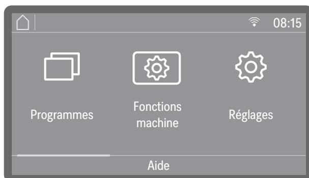
Sur les laveurs mis en réseau, un symbole indiquant l'interface disponible est affiché dans la partie supérieure de l'écran. 📶 correspond à une connexion Wi-Fi, L à une connexion LAN câblée. Si le laveur ne peut pas établir de connexion Wi-Fi avec le routeur, le symbole est barré 📶.
