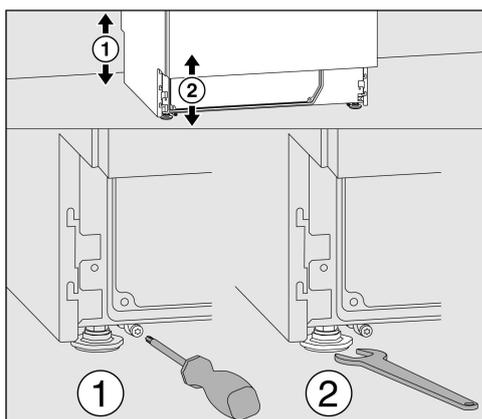
Les pieds avant de l'appareil peuvent être ajustés à l'aide d'une clé à fourche (clé de 13), les pieds arrière à l'aide d'une vis Torx T20.
