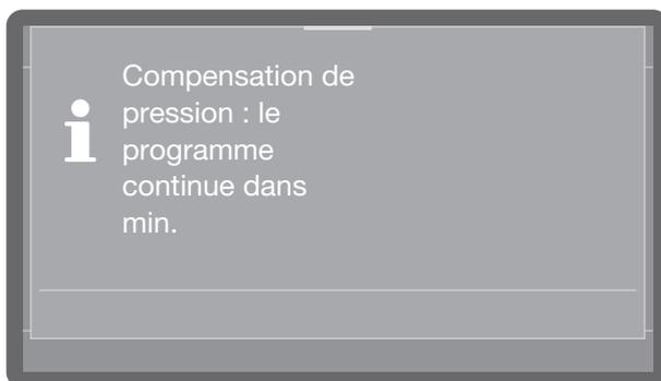
Si la température à l'intérieur de la cuve est supérieure à 60 °C à ce moment-là, la pression est d'abord égalisée. Le programme reprend ensuite.
