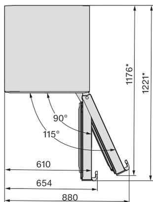
\* Dimenzija bez montiranog dodatka za odmak od zida. Ako se koriste priloženi dodaci za odmak od zida, dubina za ugradnju uređaja povećava se za 15 mm.
