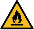
► Upozorenje: Opasnost od požara/zapaljivi materijali. Ovaj simbol se nalazi na kompresoru i označava zapaljive materijale. Ne uklanjajte ovu naljepnicu.
