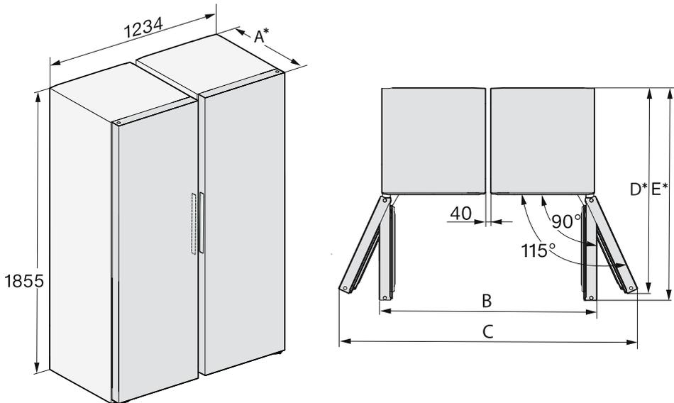
\* Dimenzija bez postavljenog dodatka za odmak od zida. Ako se koriste priloženi dodaci za odmak od zida, dubina za ugradnju uređaja povećava se za 15 mm.
