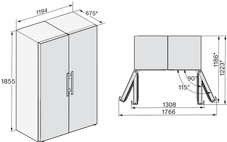
\* Dimenzija bez postavljenog dodatka za odmak od zida. Ako se koriste priloženi dodaci za odmak od zida, dubina za ugradnju uređaja povećava se za 15 mm.
