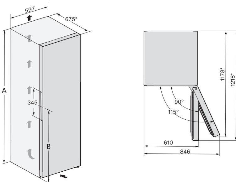
\* Dimenzija bez montiranog dodatka za odmak od zida. Ako se koriste priloženi dodaci za odmak od zida, dubina za ugradnju uređaja povećava se za 15 mm.
