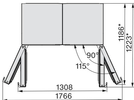
\* Dimenzija bez montiranog dodatka za odmak od zida. Ako se koriste priloženi dodaci za odmak od zida, dubina za ugradnju uređaja povećava se za 15 mm.
