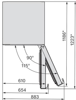
\* Dimenzija bez montiranog dodatka za odmak od zida. Ako se koriste priloženi dodaci za odmak od zida, dubina za ugradnju uređaja povećava se za 15 mm.
