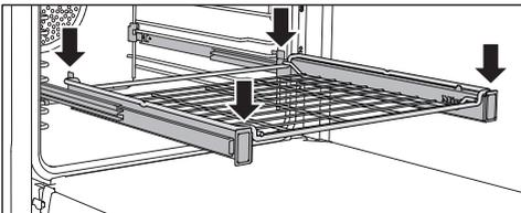
Les rails coulissants télescopiques FlexiClip peuvent supporter une charge maximale de 33 lb (15 kg).
