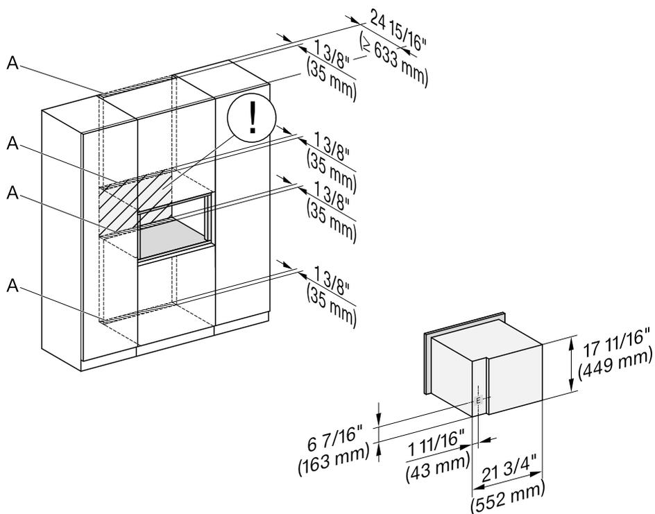
**A** Découpe (min.  $28 \text{ po}^2$  ( $18\,000 \text{ mm}^2$ )) pour le câble électrique et la ventilation
