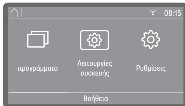
Για τις συσκευές καθαρισμού που είναι συνδεδεμένες σε θύρα επικοινωνίας, ένα εικονίδιο για τη διαθέσιμη διεπαφή εμφανίζεται στο επάνω μέρος της οθόνης. Το WiFi υποδεικνύει σύνδεση WLAN, το LAN ενσύρματη σύνδεση LAN. Εάν η συσκευή καθαρισμού δεν μπορεί να δημιουργήσει σύνδεση WLAN με το δρομολογητή, το σύμβολο διαγράφεται αντίστοιχα.
