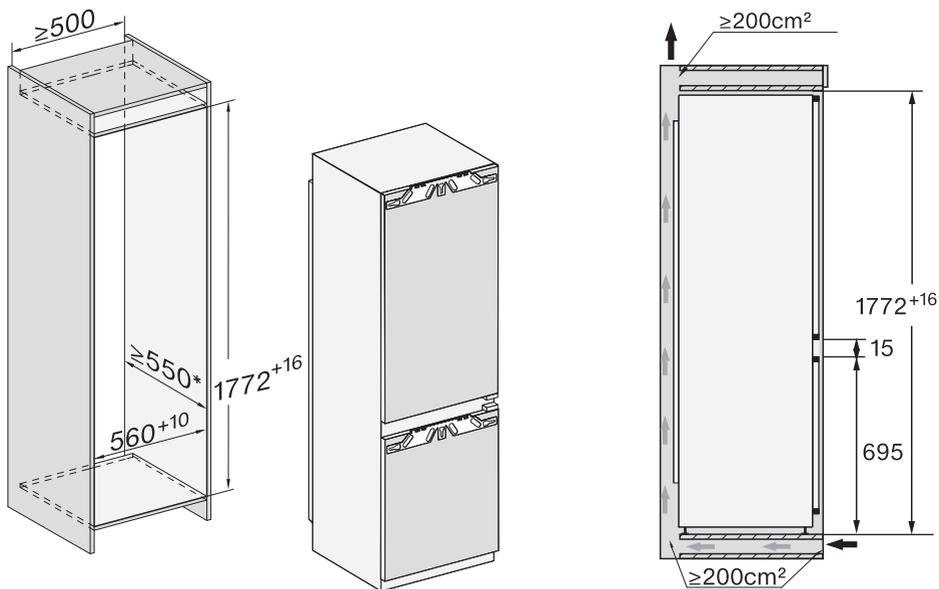
\* La consommation énergétique déclarée a été déterminée à partir d'une profondeur de niche de 560 mm. Avec une profondeur de niche de 550 mm, l'appareil fonctionne parfaitement mais consomme légèrement plus d'énergie.
