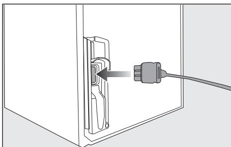
■ Vtič aparata vstavite v vtičnico na hrbtni strani hladilnega aparata.
