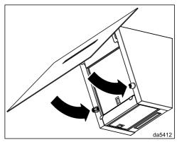
Schwenken Sie den Wrasenschirm nach unten. Er wird durch Magnete arretiert.
