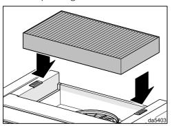
Setzen Sie den Geruchsfilter in die Aufnahme an der Oberseite der Dunstabzugshaube ein.
