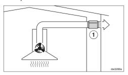
Bei Abluftbetrieb dämpft der Schalldämpfer sowohl Gebläsegeräusche nach aussen als auch Aussengeräusche, die über die Abluftleitung in die Küche dringen (z. B. Strassenlärm). Dazu wird der Schalldämpfer möglichst nah vor dem Abluftaustritt ① positioniert.
