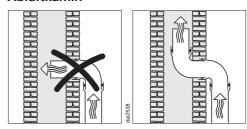
Wenn die Abluft in einen Abluftkamin geführt wird, muss der Einführungsstutzen in Strömungsrichtung gelenkt werden.
