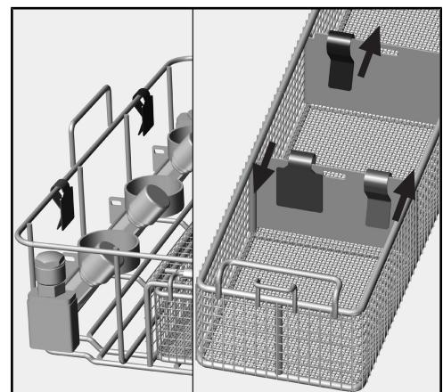
Bevestig steeds van elke kleur een label aan de houder of het rek, en een label aan de vakken van het rek voor kleine onderdelen.
