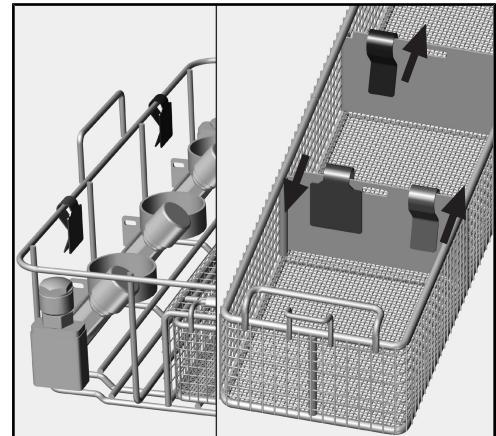
Fäst vardera en skytt av varje färg på ringhållarna eller diskgodssens hållare och en på facken för korgarna med små delar.
