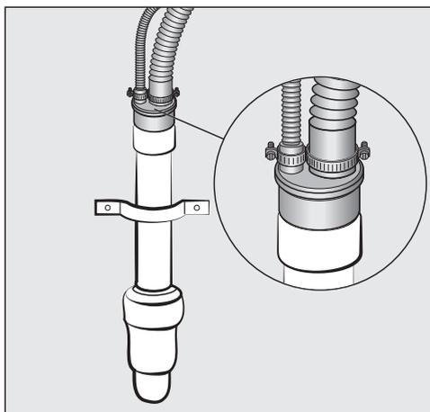
■ Insérez l'adaptateur de vidange dans le tuyau d'évacuation en plastique.
