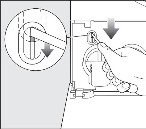
1. À l'aide d'un tournevis, appuyez à fond sur le mécanisme de déverrouillage de la porte sans la toucher ni l'ouvrir.
