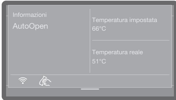
Sul bordo superiore del display è visualizzata una barra colorata. Se si preme questa barra e la si sposta verso il basso, si apre una finestra di stato. In questo modo vengono visualizzate diverse segnalazioni di stato, p.es. relative al programma in corso.
