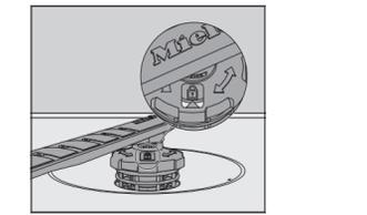
■ Drehen Sie die Verschraubung des unteren Sprüharms im Uhrzeigersinn (Blickrichtung von oben), bis der Pfeil im Sichtfenster auf das Schlosssymbol zeigt.
