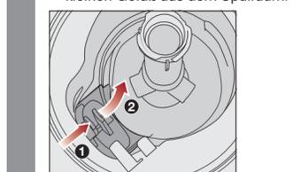
■ Drücken Sie die Verriegelung der Abdeckung der Ablaufpumpe nach innen **1**.
