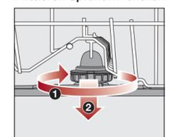
■ Drehen Sie die Verschraubung des mittleren Sprüharms im Uhrzeigersinn **1** (Blickrichtung von oben) und nehmen Sie den Sprüharm ab **2**.
