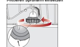
■ Setzen Sie den mittleren Sprüharm wieder ein und drehen Sie die Verschraubung gegen den Uhrzeigersinn bis sie einrastet (Blickrichtung von oben). Achten Sie darauf, dass die Aussparungen in der Verriegelung übereinander liegen.
