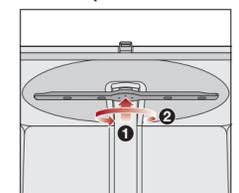
■ Drücken Sie den oberen Sprüharm hoch **1**, damit die innere Verzahnung einrastet, und schrauben Sie ihn gegen den Uhrzeigersinn ab **2** (Blickrichtung von unten).
