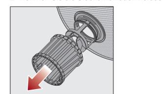
■ Zum Reinigen der Siebinnenseite ziehen Sie den Mikrofilter an dem Kunststoffring nach unten von der Siebkombination ab.
