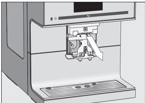
■ Снимите дозирующее устройство, потянув его вперёд.
