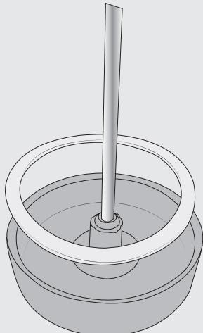
При необходимости с крышки ёмкости для молока можно снять соединительный элемент и уплотнительное кольцо. Чтобы снять трубку из нержавеющей стали, слегка выдавите соединительную деталь из внутренней части крышки.
