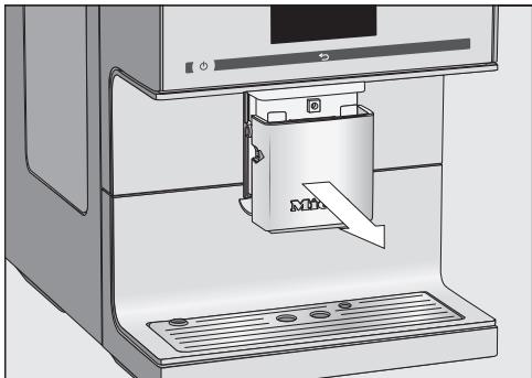
■ Снимите крышку из нержавеющей стали, сдвинув её вперёд.
