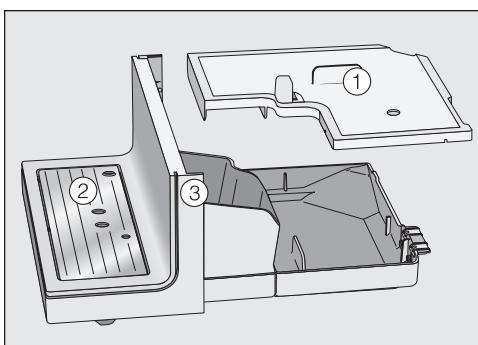
■ Снимите крышку ①, крышку поддона для жидкости ② и нижнюю панель ③.
