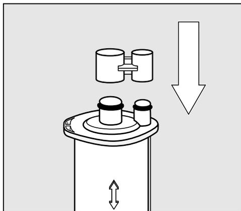
**Suggerimento:** Si può chiudere la cartuccia di decalcificazione con la copertura che si trova sul cilindro della cartuccia. Staccare la copertura dal punto rottura.
