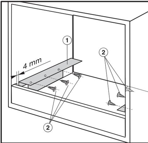
Veillez à ce qu'une distance de 4 mm soit maintenue entre le bandeau de compensation et les équerres d'appui.
