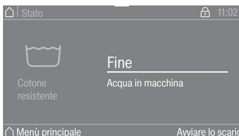
La liscivia non viene scaricata affinché possa essere riutilizzata nel programma successivo. Una volta terminato il programma, viene visualizzata la maschera/schermata di fine programma. È possibile passare con la liscivia al menù principale oppure scaricare la liscivia premendo il campo di selezione *Avviare lo scarico*. Se è necessario uno scarico automatico permanente dell'acqua, è possibile attivare lo *Scarico acqua automatico* nel livello *gestore*.
