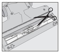
■ 用剪刀剪掉纏繞在滾筒塵刷上的所有 細線或頭髮。請沿著滾筒塵刷上的導 軌剪開。
