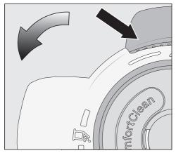
■ 沿箭頭方向,將集塵箱的遮蓋旋轉至下一擋。使用灰色的抓握表面可以幫助您完成此操作。
