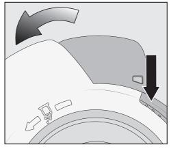
■ 沿箭頭方向,將集塵箱的遮蓋旋轉至 第一擋。使用灰色的抓握表面可以幫 助您完成此操作。
