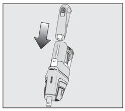
主機可以單獨使用(僅主機),無需吸管和電動吸頭,可以快速清理特定區域的碎層和絨毛。
