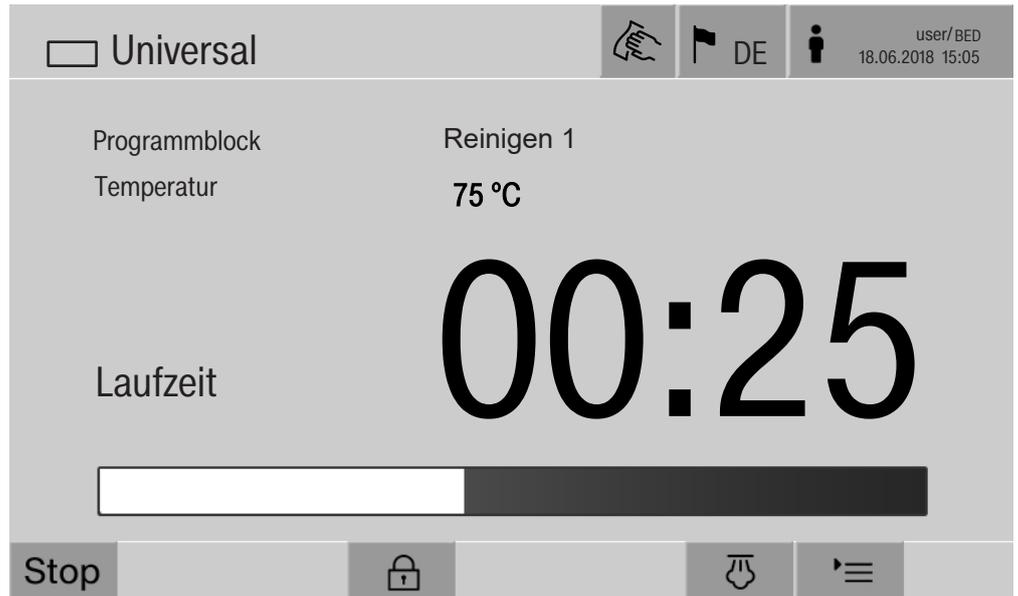
Im Display werden zusätzlich der aktuelle Programmblock und die erreichte Temperatur angezeigt.
