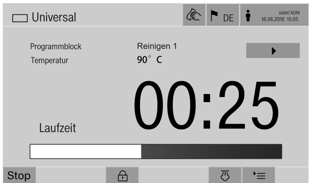
Nach dem Start des Aufbereitungsprogramms wird im Display neben dem Programmblock eine zusätzliche Schaltfläche ► eingeblendet. Die Schaltfläche ► hat zwei Funktionen:
