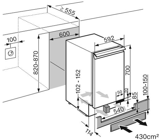
Beachten Sie vor dem Einbau, dass die Einbaunische genau den vorgegebenen Einbaumaßen entspricht. Die Be- und Entlüftungsquerschnitte müssen unbedingt eingehalten werden und der Ausschnitt in der Sockelblende für das beiliegende Lüftungsgitter muss mit dem Weinschrank zentriert sein, um eine korrekte Funktion des Weinschranks zu gewährleisten.
