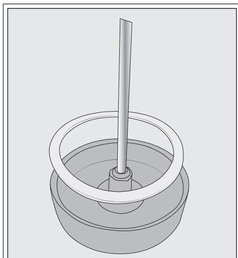
Po potrebi možete da skinete spojni deo i zaptivni prsten iz poklopca posude za mleko. Kada skinete cev od plemenitog čelika, spojni deo može malo da se izgura sa unutrašnje strane poklopca.
