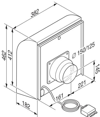
L'aspiratore da parete esterna AWG 102 è predisposto per il montaggio all'esterno dell'edificio.
