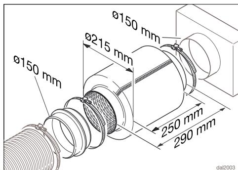
È possibile montare un silenziatore nella conduttura di scarico dell'aria che serve a ridurre il rumore.
