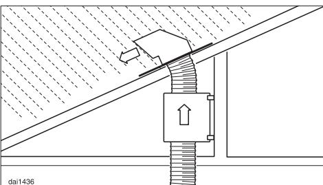
Installando l'apparecchio in posizione verticale e con evacuazione diretta attraverso il tetto, è necessario impedire che vi siano infiltrazioni di acqua piovana nella conduttura di sfiato, usando il dispositivo passante per tetti DDF 125/150 o altri dispositivi adatti allo scopo.
