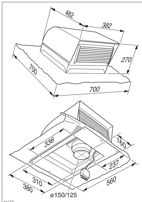
L'aspiratore da tetto DDG 102 è predisposto per il montaggio su tetti in tegole o scandole inclinati. L'inclinazione del tetto deve essere di almeno 22° affinché non possa penetrare pioggia o neve.
