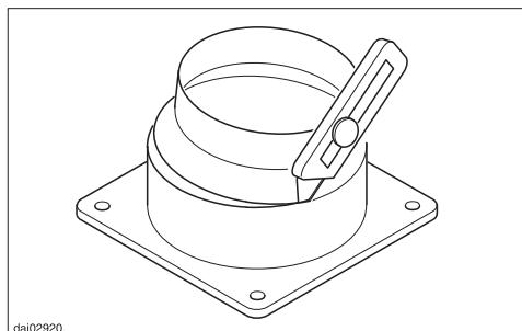
■ Per un condotto di sfiato Ø 150 mm tagliare l'anello anteriore del bocchettone di aspirazione con un coltello sul punto di rottura definito.
