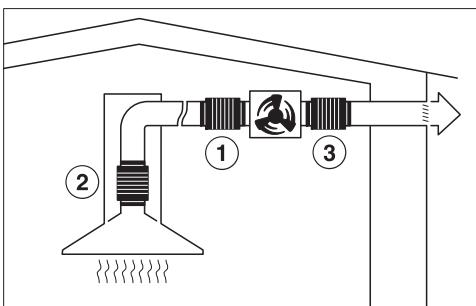
Per rendere minimi i rumori dell'aspiratore in cucina, installare il silenziatore possibilmente davanti all'aspiratore esterno ①; se invece la conduttura di scarico dell'aria è lunga, posizionarlo sul bocchettone uscita aria della cappa ②. Se l'aspiratore esterno è montato all'interno della casa (ABL 202), posizionando il silenziatore dietro l'aspiratore esterno ③ si rende possibile una riduzione del rumore verso l'esterno.
