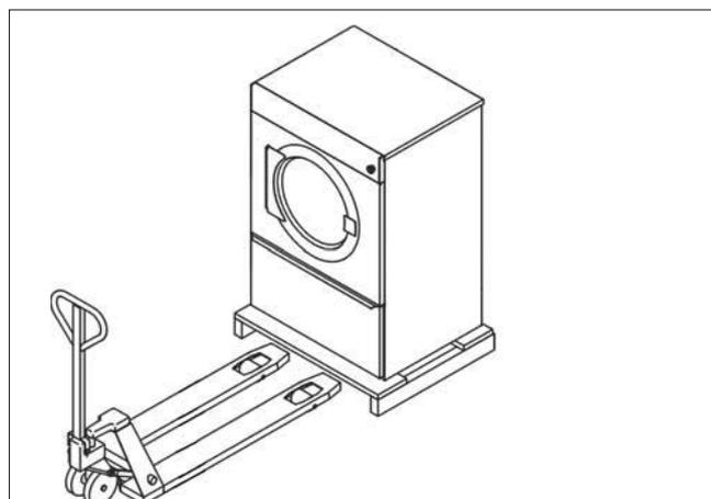
Sur le site d'installation, le sèche-linge doit être soulevé de la palette de transport à l'aide d'un engin de levage approprié.
