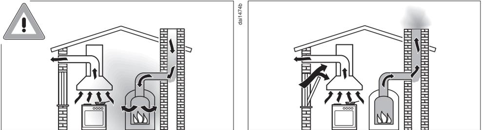
**⚠** Vergiftungsgefahr durch Verbrennungsgase.
