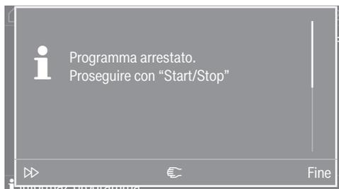
Se viene selezionato Svolgimento rapido  $\gg$ , è possibile selezionare il blocco programma desiderato per l'ulteriore esecuzione tramite il display dell'unità di comandi.
