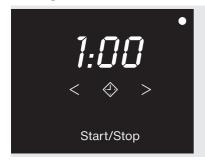
Effleurez la touche sensitive < ou > jusqu'à ce que le départ différé souhaité s'allume dans l'affichage de temps.
