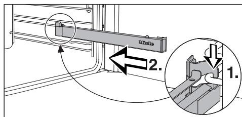
■ Vodilo FlexiClip spredaj zataknite na spodnjo prečko želenega nivoja vstavljanja (1.) in ga potisnite vzdolž prečke v pečico (2.).
