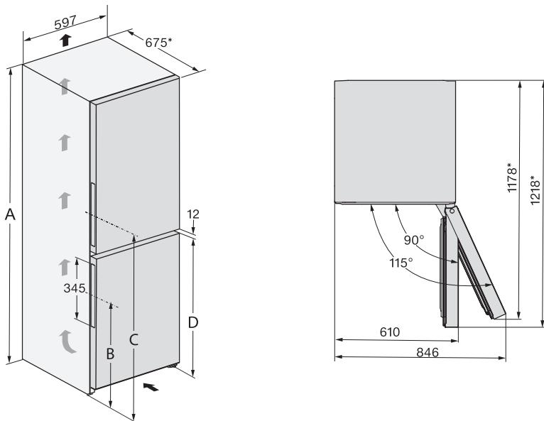
\* Διάσταση χωρίς εγκατεστημένους αποστάτες τοίχου. Αν χρησιμοποιηθούν οι συνοδευτικοί αποστάτες τοίχου, το πάχος της συσκευής αυξάνεται κατά 15 mm.
