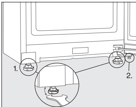
■ Ευθυγραμμίστε τη συσκευή με τη βοήθεια ενός αλφαδιού και με το συνοδευτικό διπλό κλειδί και στηρίξτε την πόρτα της συσκευής.
