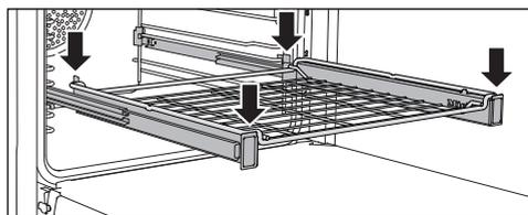
FlexiClip 灵动滑轨最大可承受 15 千克的负载。
