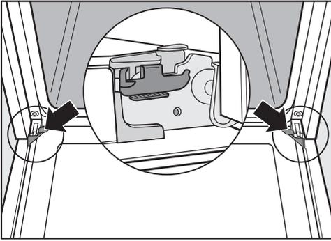
烤箱门通过夹持器与门铰链相连。从夹持器上拆卸机门之前，必须松开两个机门铰链上的锁紧夹头。
