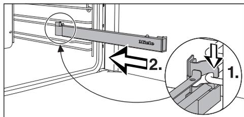
■ 将 FlexiClip 灵动滑轨钩在搁架层较低轨道的前部 (1.)，然后沿轨道将其推进烤箱内腔 (2.)。
