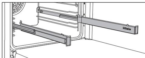
您可在搁架层 1-3 上使用 FlexiClip 灵动滑轨。
