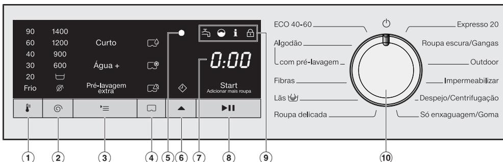
① **Tecla sensora** 🌡️ (Temperatura) para ajustar a temperatura de lavagem pretendida
