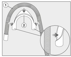
■ Fissare il gomito ② al tubo di scarico ①.
