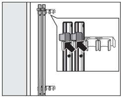
Fissare le barre di trasporto sulla parete posteriore della lavatrice. Assicurarsi che il gancio superiore si trovi sopra il supporto. Danni dovuti a un trasporto errato.
