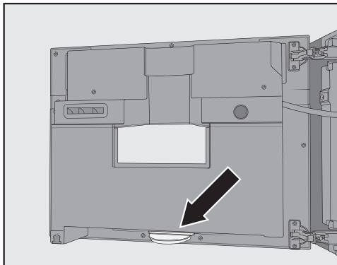
滴漏盘位于电器机门内侧的底部。
