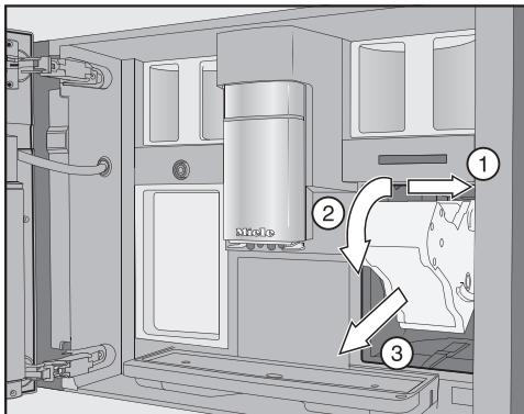
■ 首先，从侧面拉出冲泡器 ①，然后将其向前滑出 ③。进行此操作时，请将冲泡器向前倾斜 ②。
