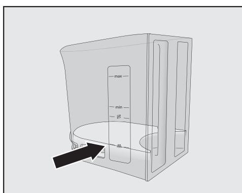
■ 将微温的水注入水箱，直至水位达到 **|||** 标记处，然后搅拌溶液。
