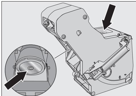
■ 擦拭过滤器上的咖啡残留物。一个过滤器位于漏斗中。另一个过滤器位于漏斗左侧。
