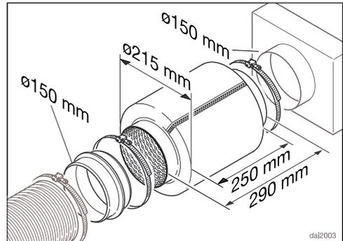
Zur zusätzlichen Schalldämpfung kann in die Abluftleitung ein Schalldämpfer eingesetzt werden (nachkaufbares Zubehör).
