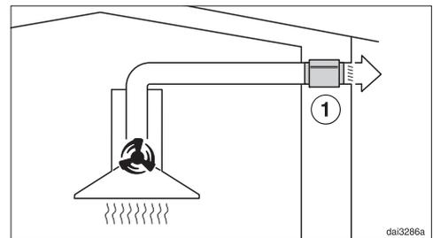
Bei Abluftbetrieb dämpft der Schalldämpfer sowohl Gebläsegeräusche nach aussen als auch Aussengeräusche, die über die Abluftleitung in die Küche dringen (z. B. Strassenlärm). Da-
