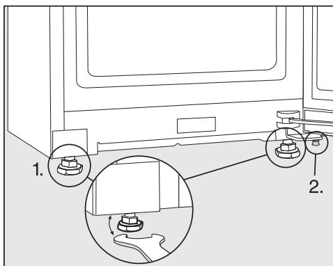
■ Ευθυγραμμίστε τη συσκευή με τη βοήθεια ενός αλφαδιού και με το συνοδευτικό διπλό κλειδί και στηρίξτε την πόρτα της συσκευής.
