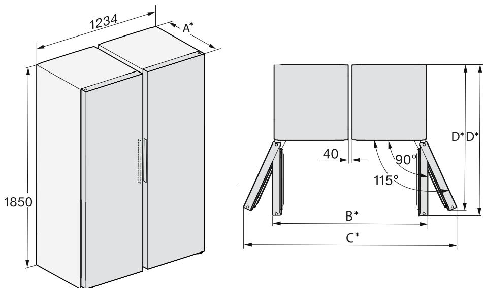
\* Διάσταση χωρίς εγκατεστημένους αποστάτες τοίχου. Αν χρησιμοποιηθούν οι συνοδευτικοί αποστάτες τοίχου, το βάθος της συσκευής αυξάνεται κατά 15 mm.
