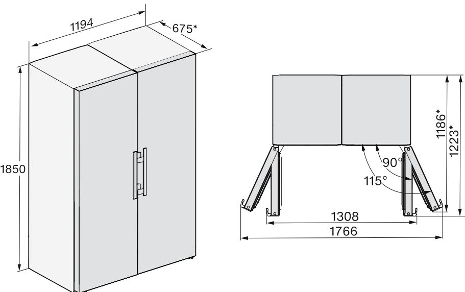
\* Διάσταση χωρίς εγκατεστημένους αποστάτες τοίχου. Αν χρησιμοποιηθούν οι συνοδευτικοί αποστάτες τοίχου, το βάθος της συσκευής αυξάνεται κατά 15 mm.
