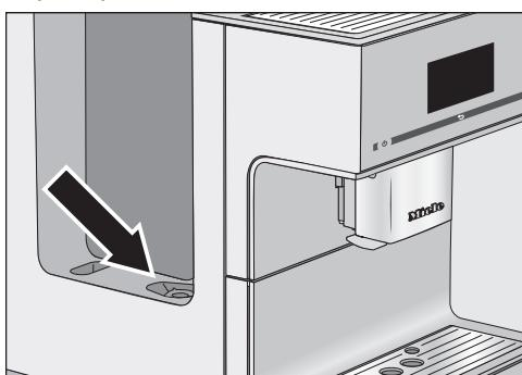
Цедката на водния резервоар се намира под резервоара.
