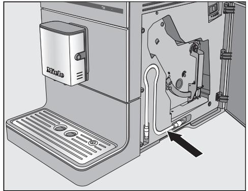
Le conduit de lait peut se ranger derrière la trappe.
