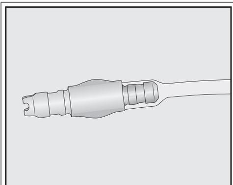
Se è stato staccato il raccordo dal condotto del latte: quando lo si riassume, tenere conto che il lato più piccolo e sottile del raccordo sia inserito nel tubo.
