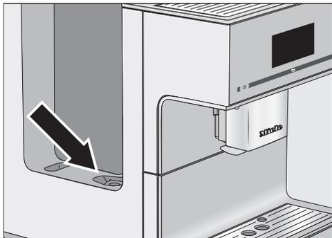
Il filtro del serbatoio dell'acqua si trova sotto il serbatoio.
