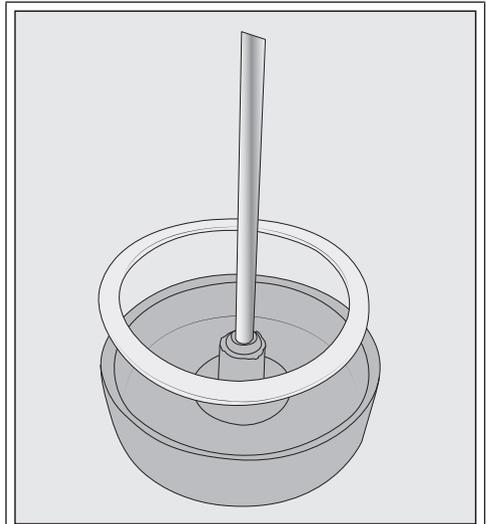
Se necessario, è possibile rimuovere il raccordo e l'anello di guarnizione dal coperchio del contenitore del latte. Dopo aver tolto il tubo in acciaio inossidabile, si può spingere fuori leggermente il raccordo dall'interno del coperchio.
