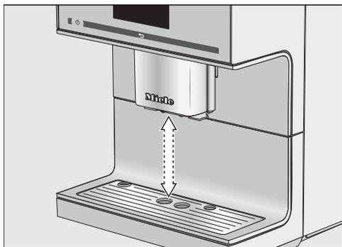
**Non** è possibile regolare manualmente l'erogatore centrale con il sensore bordo tazza.
