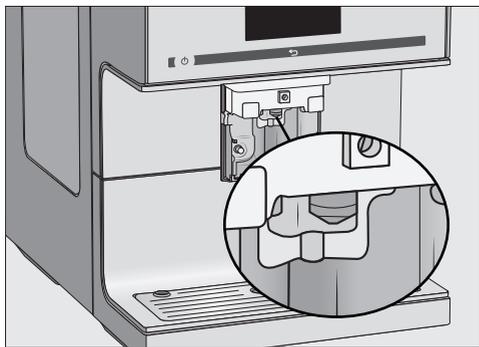
Infilare la spazzola di pulizia al max. 1 cm all'interno dell'ugello del vapore.
