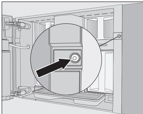
I skruehullet er det en rød silikonknapp som sikrer døren under transport og dermed forhindrer transportskader.
