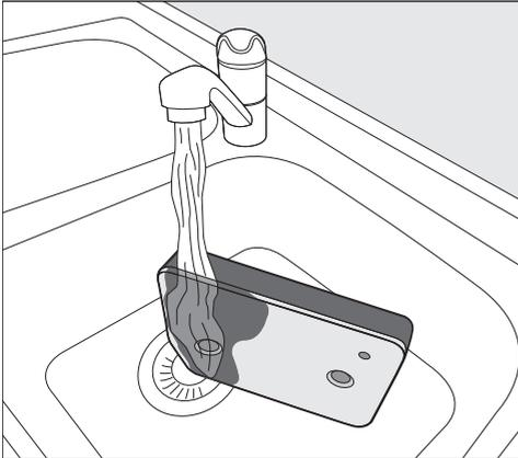
**Tipp:** Damit sich vorhandene Rückstände auf der Oberfläche schneller lösen, lassen Sie einen Wasserstrahl senkrecht über die Vorderseite des Sockelfilters laufen.
