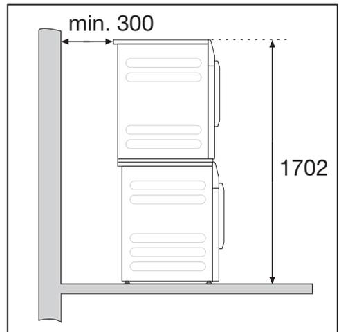
Ein Verbindungssatz\* ist erforderlich. Die Montage muss durch eine von Miele autorisierte Fachkraft erfolgen.
