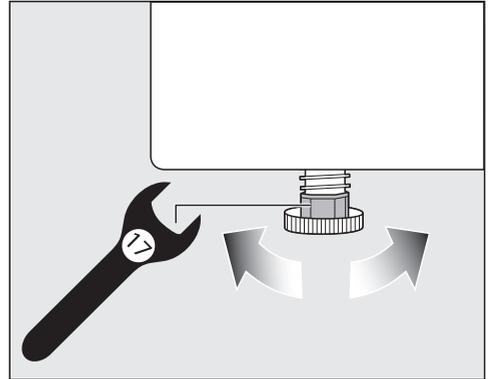
Bodenunebenheiten können Sie durch Drehen der Schraubfüße ausgleichen.
