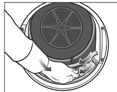
Reinigen Sie nach jedem Programmlauf und immer wenn diese Aufforderung im Display leuchtet: Reinigen Sie den Flusenfilter und waschen Sie den Sockelfilter..
