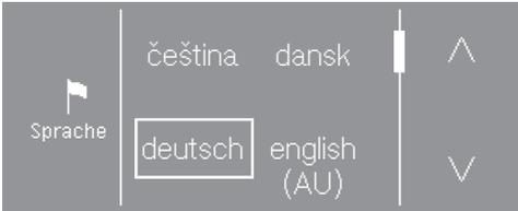
Durch Berühren der Sensortaste  $\vee$  bewegt sich die Auswahlliste nach unten. Durch Berühren der Sensortaste  $\wedge$  bewegt sich die Auswahlliste nach oben.
