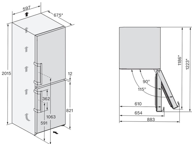
\* Dimensões sem distanciadores de parede montados. Se os distanciadores de parede fornecidos forem utilizados, a profundidade do aparelho aumenta em 15 mm.
