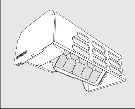
Mal a água tenha congelado, os cubos de gelo caem automaticamente da cuneta de cubos de gelo integrada para a gaveta. A cuneta de cubos de gelo não é removível.
